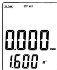
Надлежащим образом поместите верхушку прибора в площадь сечения канала, проведите измерение, снова нажмите кнопку "OPTION" (Выбор), чтобы выйти из режима измерения 2/3 от
