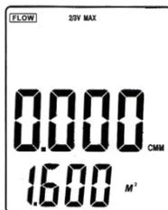
Надлежащим образом поместите верхушку прибора в площадь сечения канала, проведите измерение, снова нажмите кнопку "OPTION" (Выбор), чтобы выйти из режима измерения 2/3 от
